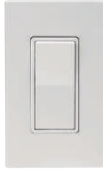
Interruptor 3 vías 15A 120/277V~ Cat. 5603-2 Iluminado Cat. L5613
