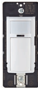
Sensor Universal Encendido automático 400VA~ 60Hz 180° PIR 300W LED / CFL 600W Incandescente 1/4 hp 5A 1 Polo Encendido relay Requiere tierra Cat. DOS05
