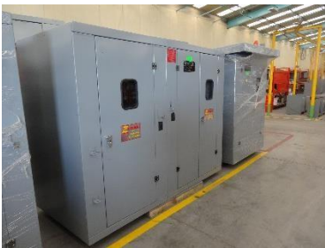
1 Subestación Compacta de 25 kV, 3 Transformadores tipo seco de Media Tensión de 500 y 1600 kVA
