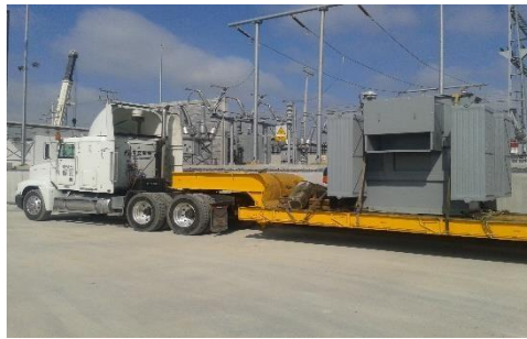
Transformador de Potencia de 5.75 MVA
