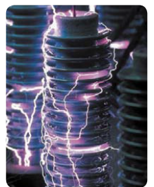
Imagen de descargas en la superficie de un aislador.
