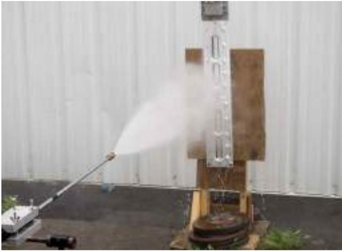
Diseñadas para soportar 2,000 psi de presión a 1.5 m
