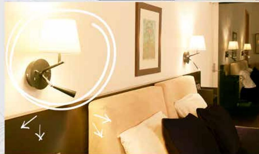
**Con base GU10:** Puedes alargar la vida útil de tu luminario remplazando la lampara gracias a que tienen integradas bases GU10 para integrar lámparas tipo MR16
