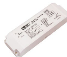
Driver Voltaje: 100-277 V~ Watts: 75 W IP 20 - IK 7 - 0.33 Kg Voltaje de salida: 24V
