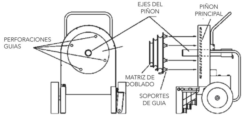
La dobladora eléctrica de conduit Burndy® BEB122 está diseñada para doblar conduit rígido de 1/2" – 2", IMC, EMT y PVC recubierto de 2". La BEB122 asiste al contratista eléctrico en trabajos extensos en los que le ayudarán a reducir el tiempo y trabajo.
